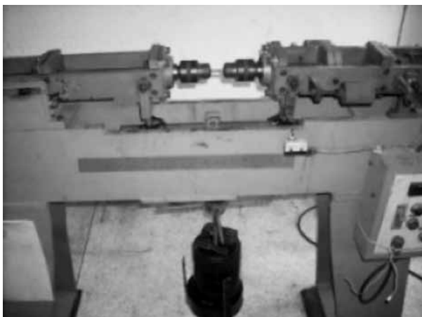
ภาพ 2 แสดงลักษณะเครื่องทดสอบความล้า (รอบการหมุนคงที่ 1,430 รอบต่อนาที)
