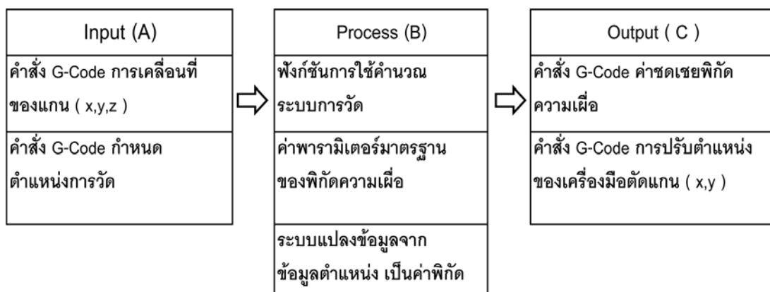
ภาพ 4 กระบวนการทำงานและตัวแปรควบคุมของอุปกรณ์เครื่องมือวัดแบบอัตโนมัติ
