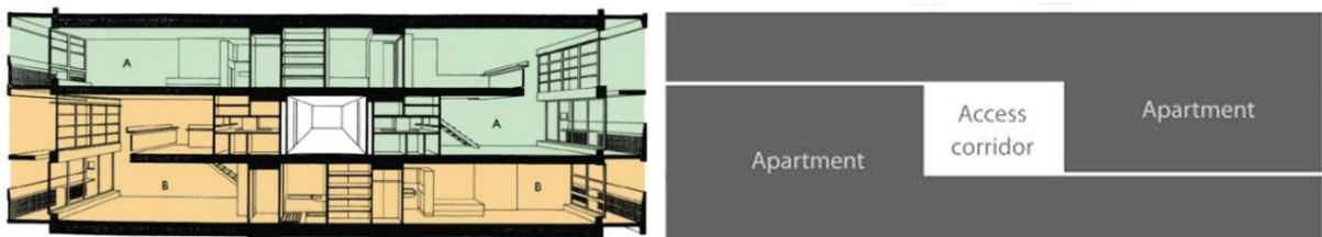
ภาพ 2 แสดงกราฟิกของรูปตัดของห้องชุดพักอาศัยของอาคารยูนิเตด ดาปิตาซียง ที่มีลักษณะเป็นรูปตัวแอล “L” จัดคว่ำ หางยเลียนประสาน อินเทอร์ล๊อค (interlock) กันอยู่
