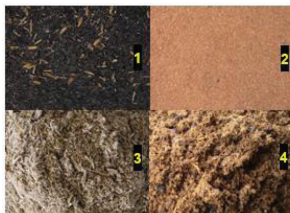
ภาพ 1 วัตถุดิบที่ใช้ทดสอบ (1) แกลบเผา (2) ชานอ้อย (3) ทะลายปาล์ม (4) เห้ง้ามันสำปะหลัง
