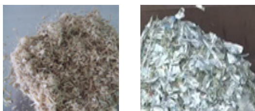
ภาพ 2 วัตถุดิบในการผลิตกระเบื้องการผลิตกระเบื้องหลังคาจากพลาสติกพอลิจากกล่องดื่มที่ใช้แล้วรวมกับของเหลือใช้ทางการเกษตร
