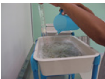
ภาพ 5 การทดสอบการรั่วซึมน้ำการผลิตกระเบื้องหลังคาจากพลาสติกพอลีจากกล่องดื่มที่ใช้แล้วรวมกับของเหลือใช้ทางการเกษตร
