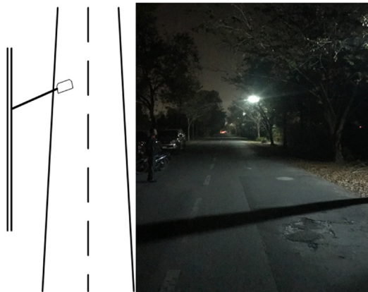
ภาพ 14 การทดสอบวัดค่าความสว่าง หลอด LED ขนาด 20 W 50 W และ 100W แบบมีแขนยื่น
