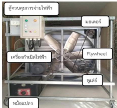
ภาพ 1 ส่วนประกอบพัดลมระบายอากาศสำหรับผลิตพลังงานไฟฟ้า
