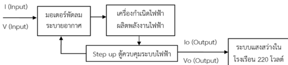
ภาพ 3 บล็อกไดอะแกรมการทำงานของมอเตอร์ร่วมกับเครื่องกำเนิดไฟฟ้า
