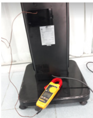
ภาพ 7 การตรวจวัดอุณหภูมิที่แกนกลางของขดลวดความร้อนสำหรับพัดลมที่ทำการติดตั้งอุปกรณ์กระจายน้ำยาไถ่
