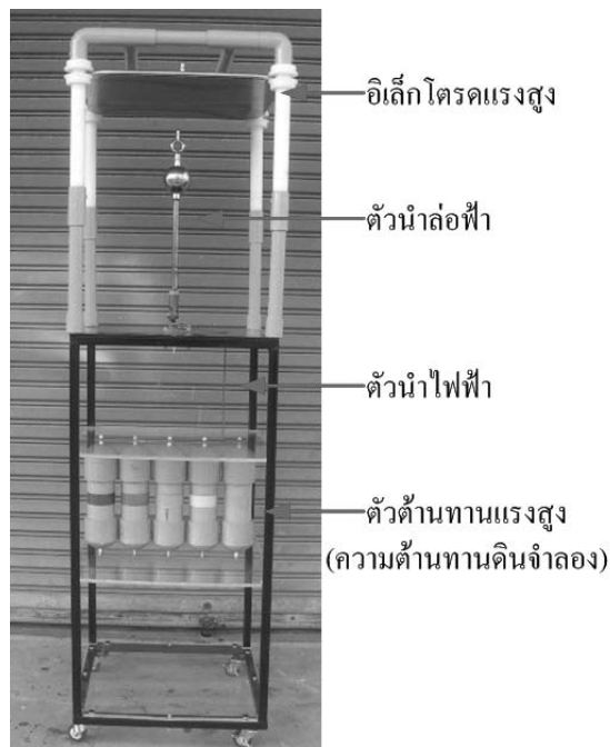
ภาพ 7 ชุดทดสอบเปรียบเทียบประสิทธิภาพการล่อฟ้า จากรูปลักษณะตัวนำล่อฟ้าและค่าความต้านทานดิน
