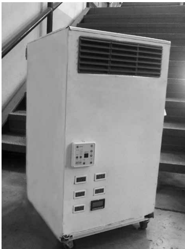
ภาพ 5 เครื่องปรับอากาศพร้อมชุดควบคุม
