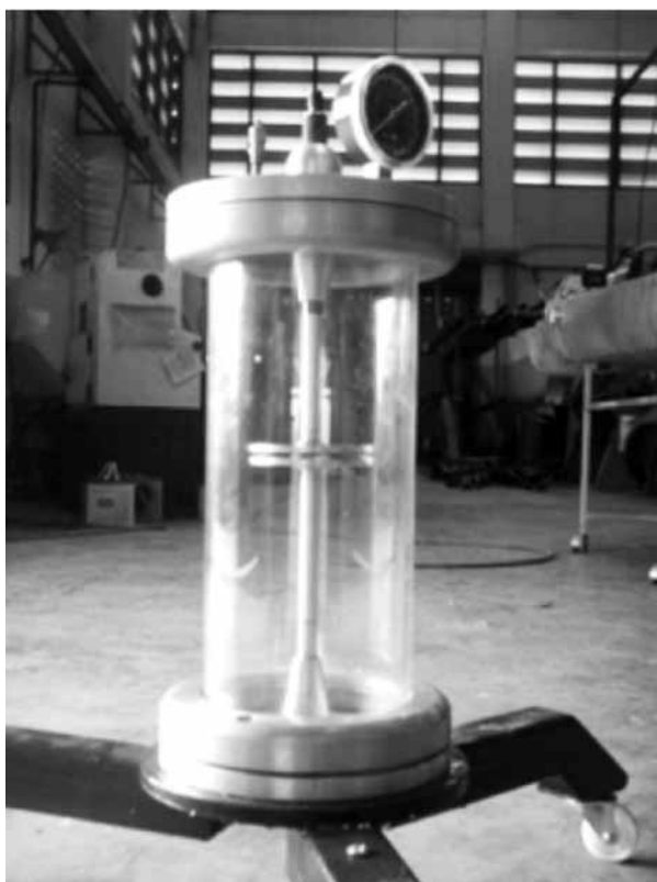
ภาพ 5 ภาพถ่ายชุดทดสอบแรงดันไฟฟ้าเบรกดาวน์ในฉนวนอากาศที่ออกแบบสร้าง
