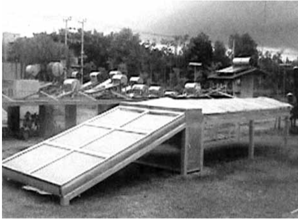
ภาพ 7 เครื่องอบแห้งพลังงานแสงอาทิตย์แบบอุโมงค์ ที่มา.จาก “เครื่องอบแห้งพลังงานแสงอาทิตย์แบบ อุโมงค์เพื่อใช้ในการแปรรูปผลิตภัณฑ์ทางการเกษตร,” โดย วัฒนพงษ์ รัชชวิเชียร, ปี 2544, ภาควิชาฟิสิกส์ คณะวิทยาศาสตร์ มหาวิทยาลัยนครสวรรค์.
