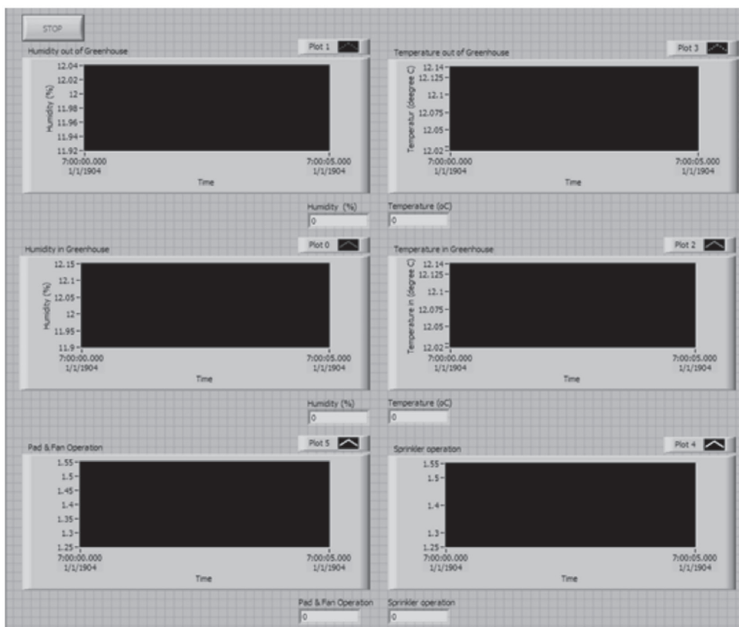
ภาพ 8 Front Panel ของระบบวัดที่เขียนบนโปรแกรม LabVIEW
