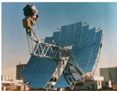
ภาพ 1 เครื่องยนต์สเตอร์ลิงผลิตกระแสไฟฟ้าโดยใช้ความร้อนจากแสงอาทิตย์
