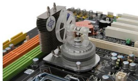
ภาพ 2 การใช้เครื่องยนต์สเตอร์ลิงระบายความร้อนจากหน่วยประมวลผลกลางของคอมพิวเตอร์
