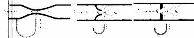
ภาพ 1 เครื่องมือวัดอัตราการไหลชนิดเวนจูรี หัวฉีด และออริฟิสต์ ตามลำดับ
