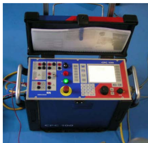
ภาพ 5 อุปกรณ์ที่ใช้วัดค่าความจุไฟฟ้า
