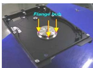
ภาพ 3 ตำแหน่งในการวัดความสูงของปิก Hub ทั้ง 3 ตำแหน่ง
